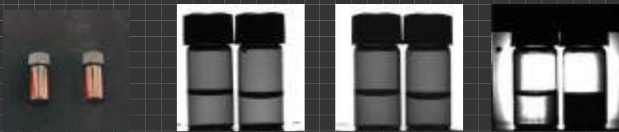
茶褐色瓶 (左:植物油, 右:水) 本体:硼珪酸ガラス キャップ:PP IH-108/114W (可視光) IFD-200/200IR-850 (850nm) IDBA-C50/50IR-1450S-C1 (1450nm)
