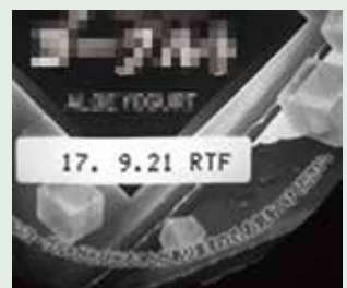
照明:IFHA-150W (LWD=20mm) ハレーションによる色ムラが発生せず、印字や外周の文字が明瞭に認識できる
