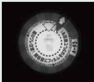
照明:IFHA-150W (LWD=15mm) 塗装やシュリンクの反射が抑えられ、印刷の明瞭な認識ができる
