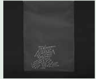
照明:IFHA-150W (LWD=10mm) 表面のハレーションが抑えられ、内部の員数検査も容易
