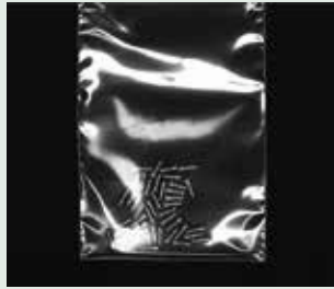
リング照明:IMAR-130DW (LWD=100mm) 袋表面でハレーションが発生し、袋内部の員数検査には不向き
