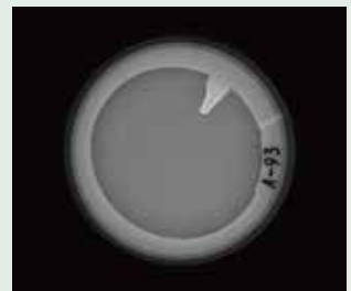
照明:IFHA-150IR-850 (LWD=15mm) 赤外により印字以外の印刷を消すことができ、印字部の認識や傷・ゴミ等の認識ができる
