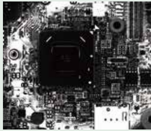
リング照明:IMAR-130W (LWD=100mm) 発光部に近い部分ではハレーションが発生し、カメラ穴のある中央部では暗くなる
