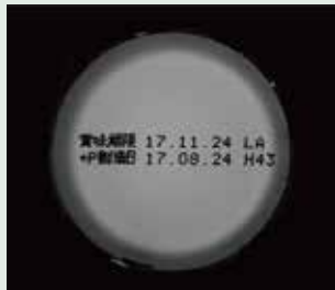
リング照明:IMAR-130DW (LWD=60mm) 印字部周囲に影が映り込み、文字の判別が難しい
