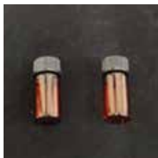
茶褐色瓶 (左:植物油、右:水) 本体:硼硅酸ガラス キャップ:PP
