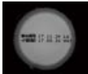
(使用照明:IMAR-130DW) WD = 60mm 印字部周囲に影が映り込み、文字の判別が難しい
