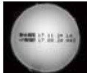
(使用照明:IFHA-C150W) WD = 10mm 影の映り込みが少なく、文字判別が容易
