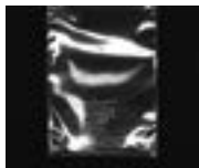
(使用照明:IMAR-130DW) WD = 100mm 袋表面でハレーションが発生し、袋内部の員数検査には不向き
