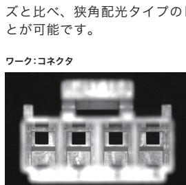
(使用照明:同軸照明 偏光板なし)
