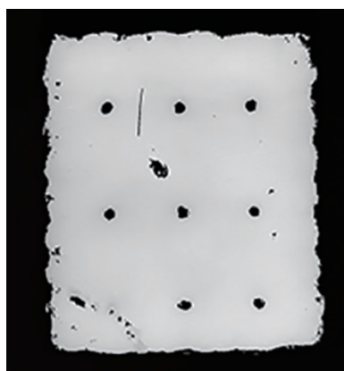
割れ、異物などの異常を モノクロ画像として表示
