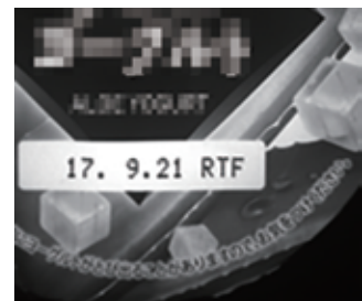
照明:IFHA-C150W (LWD=20mm) ハレーションによる色ムラが発生せず、印字や外周の文字が明瞭に認識できる
