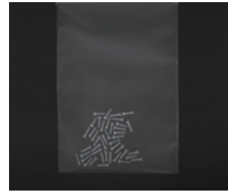
照明:IFHA-C150W (LWD=10mm) 表面のハレーションが抑えられ、内部の員数検査も容易
