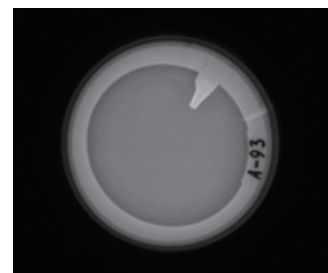
照明:IFHA-C150IR-850 (LWD=15mm) 赤外により印字以外の印刷を消すことができ、印字部の認識や傷・ゴミ等の認識ができる
