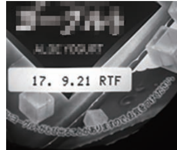
照明:IFHA-150W (LWD=20mm) ハレーションによる色ムラが発生せず、 印字や外周の文字が明瞭に認識できる
