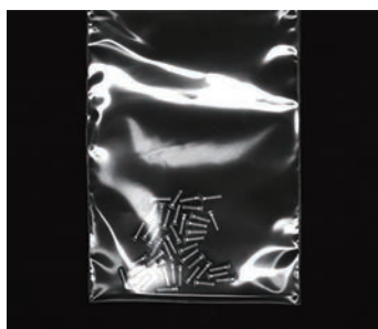
リング照明: IMAR-200W (LWD=80mm) 袋表面でハレーションが起き、 袋内部の員数検査には不向き
