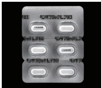
リング照明: IMAR-200W (LWD=70mm) 光が反射する曲面部の外周部分は 明るい、錠剤の影が暗く発生する
