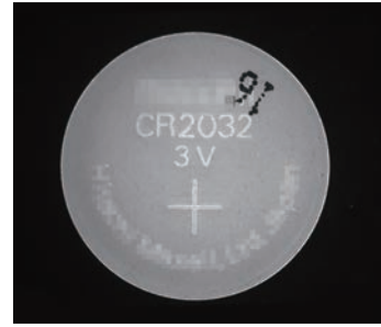
照明: IFHA-150W (LWD=20mm) 刻印と印字が同時に認識できる 表面の汚れ等は抑制される
