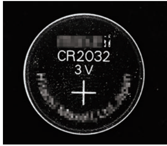
ドーム照明: IDDA-KH120AW (LWD=10mm) 刻印は見えるが印字が認識できない 表面の汚れ等が認識される
