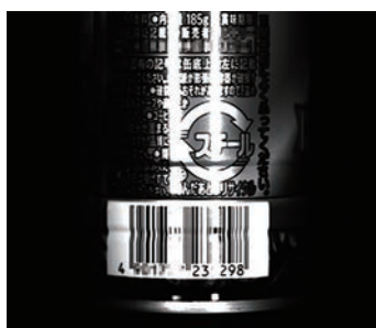
バー照明:バー照明2本斜方照射 照明が映り込み、曲面にある バーコード等が読めない
