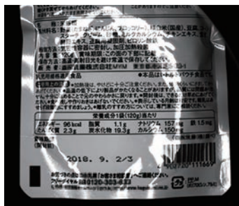
リング照明:IMAR-200W (LWD=70mm) 表面でハレーションが起き、 文字の認識が出来ない
