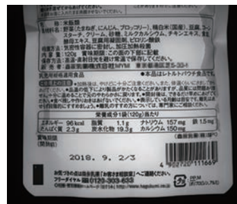
照明:IFHA-150W (LWD=5mm) ワーク全体が明るく、印字も明確に見える
