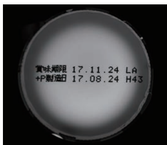
リング照明:IMAR-130W (LWD=60mm) 印字部周囲に影が映り込み、文字の判別が しにくい
