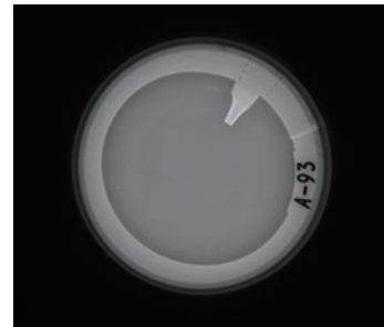
照明:IFHA-150IR-850 (LWD=15mm) 透過により印字以外の印刷を消すことが出来る 印字部の認識や傷・ゴミ等の認識が可能
