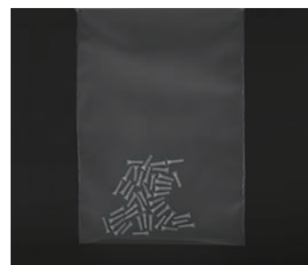
照明: IFHA-150W (LWD=10mm) 表面のハレーションが抑えられ、 内部の員数検査も容易
