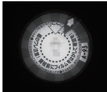
照明:IFHA-150W (LWD=15mm) 塗装やシュリンクの反射が抑えられ、 印刷の明瞭な認識が出来る
