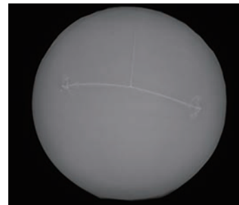
照明:IFHA-150IR-850 (LWD=15mm) 印刷インクを透過する為、印刷を消すことが出来る 印字部の傷やゴミ等の認識が可能
