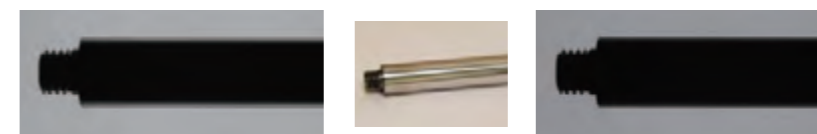
金属シャフトの寸法計測には光の回り込みを防ぐ狭角配光タイプが最適です。
