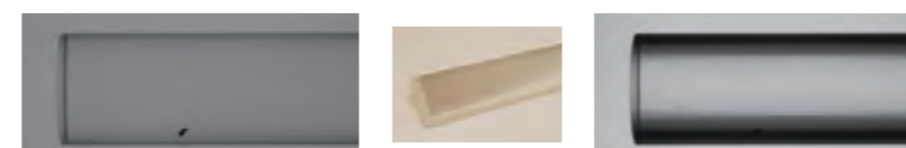
樹脂製品内部の異物検査には透過しやすい拡散光タイプが最適です。
