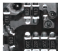
WD=60mm パターンと電極を強調出来ている
